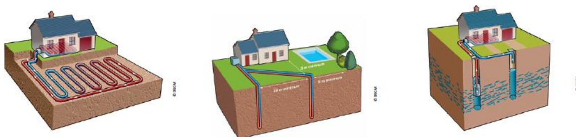
Figure 85 : Capteurs horizontaux / Sondes géothermiques verticales / pompe à chaleur sur nappes ou sur aquifères
