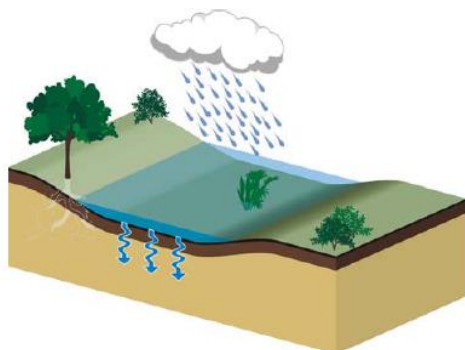
Figure 9 : Noue engazonnée et plantée infiltrante.
