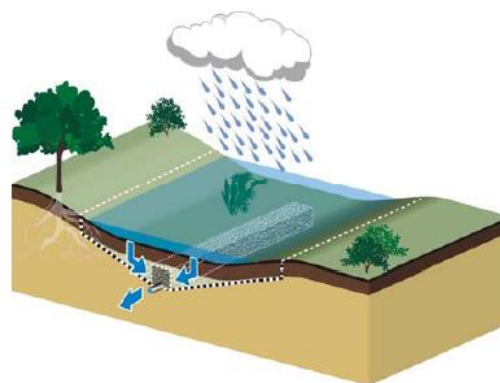
Figure 10 : Noue de rétention imperméabilisée artificiellement, avec massif drainant.
