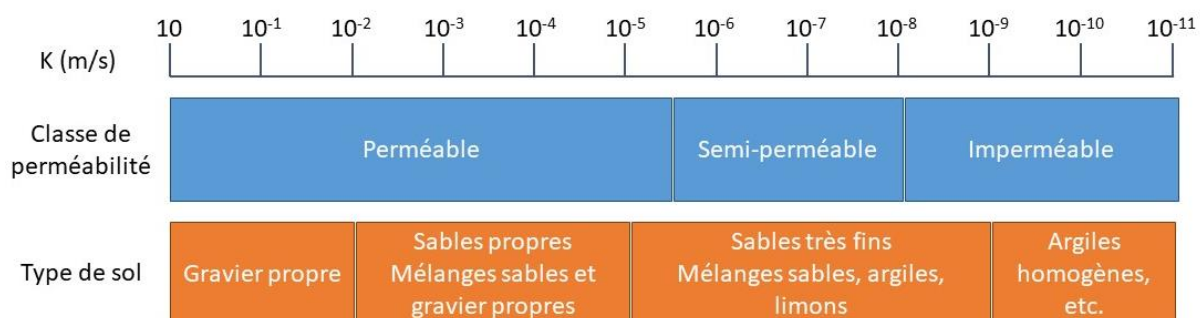
Figure 87 : Type de sol et classe de perméabilité en fonction du coefficient de perméabilité
