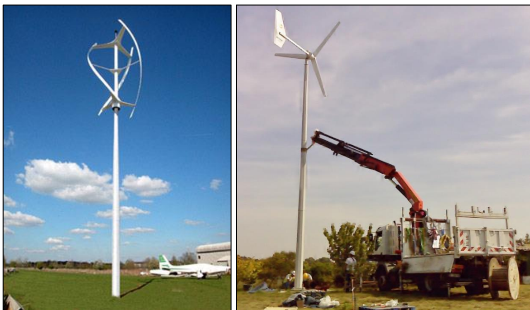
Photographie 2 : éolienne à axe vertical (gauche) et éolienne à axe horizontal (droite) - Source : SER
