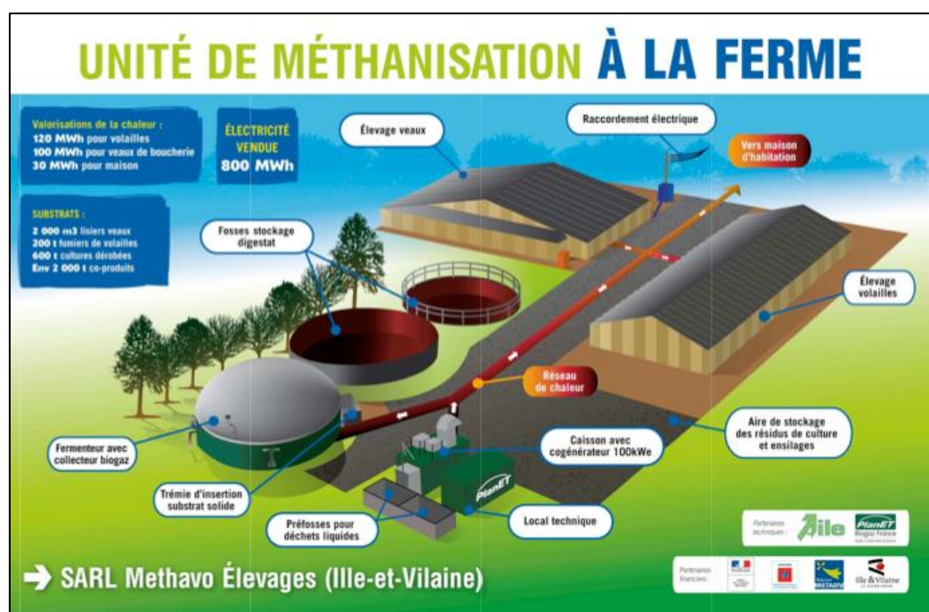
Figure 84 : Exemple d'unité de méthanisation
